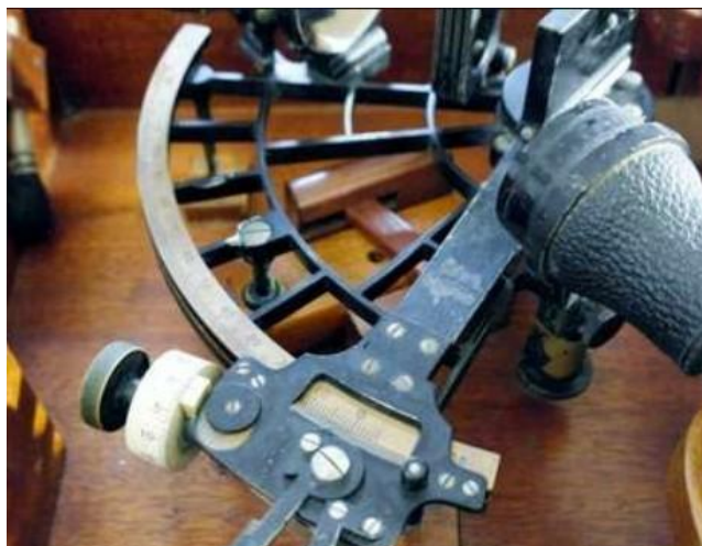
Sestante Plath con vite micrometrica (foto da web)
