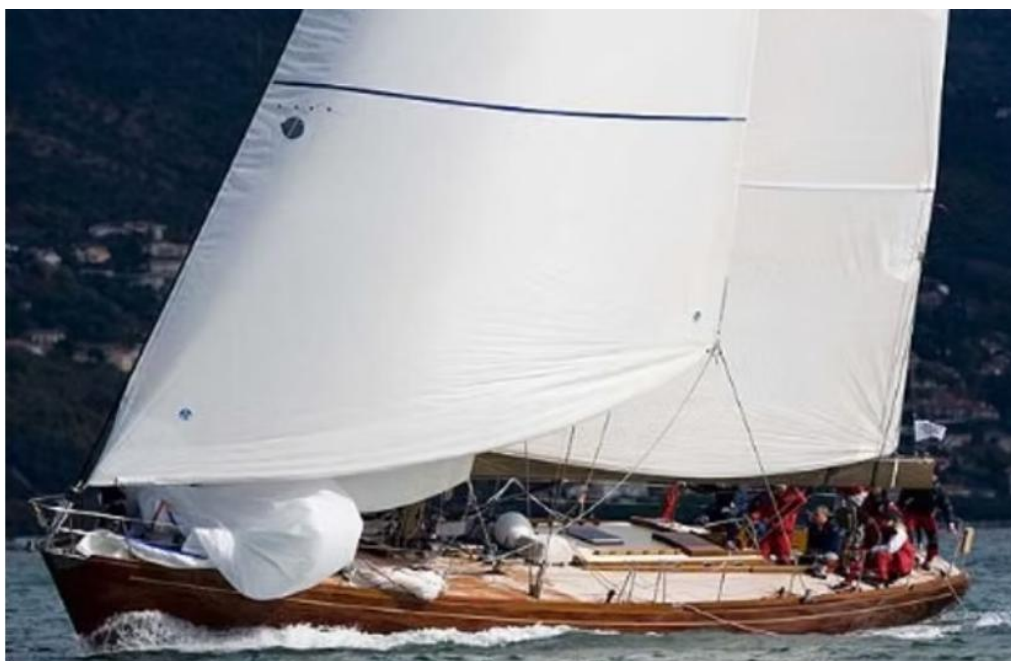
Sciarrelli 27, 9 m, 1967, con scafo in doppio lamellare in legno, coperta sempre in legno e tuga in teak.
