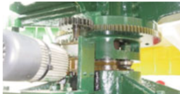
Particolare degli apparati che assicurano la rotazione della lanterna
