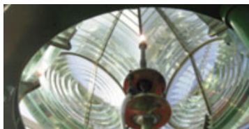
Questa piccola lampada, grazie alla lanterna dotata di lenti di Fresnel, garantisce una portata luminosa di 25 miglia nautiche !
